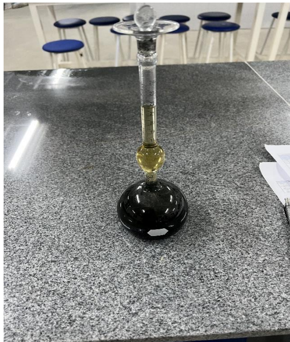
Figura 6 - Ensaio da massa específica da borracha
