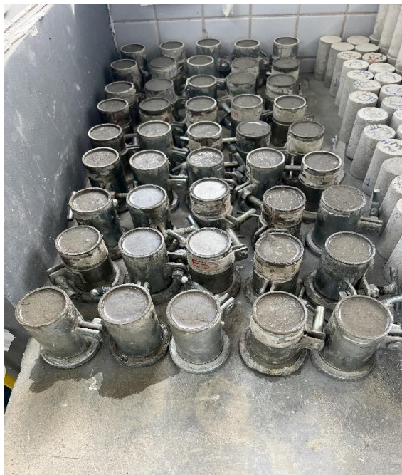
Figura 22 - Corpos de prova moldados ainda em processo de cura durante as 72hs iniciais no molde
