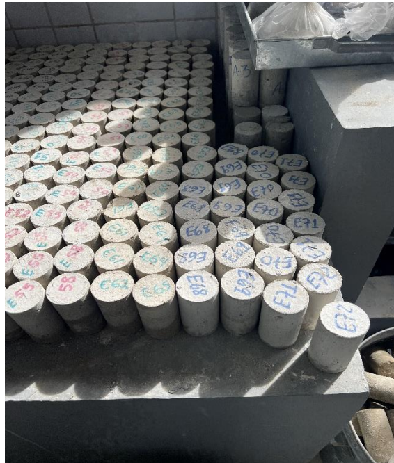
Figura 23 - Corpos de prova mantido em temperatura ambiente depois das 72hs iniciais e aguardando completar os 28 dias para o ensaio
