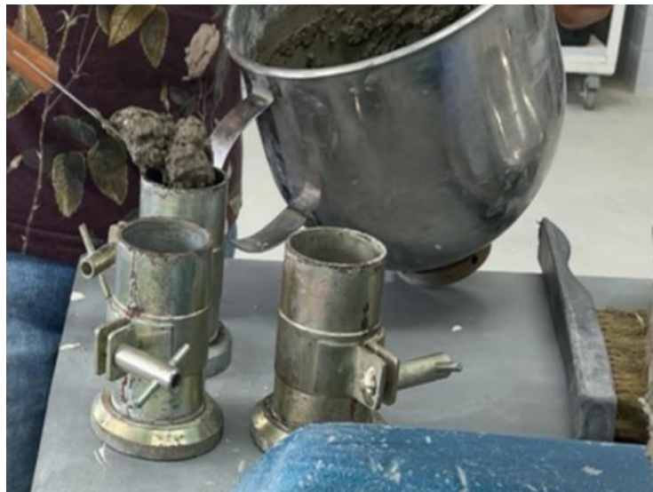
Figura 21 - Moldagem dos corpos de prova
