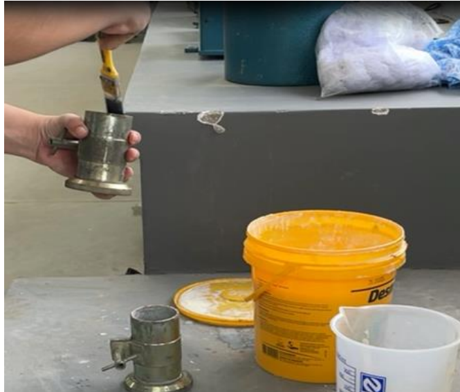
Figura 20 - Processo de colocação do desmoldante em todo o molde do corpo de prova
