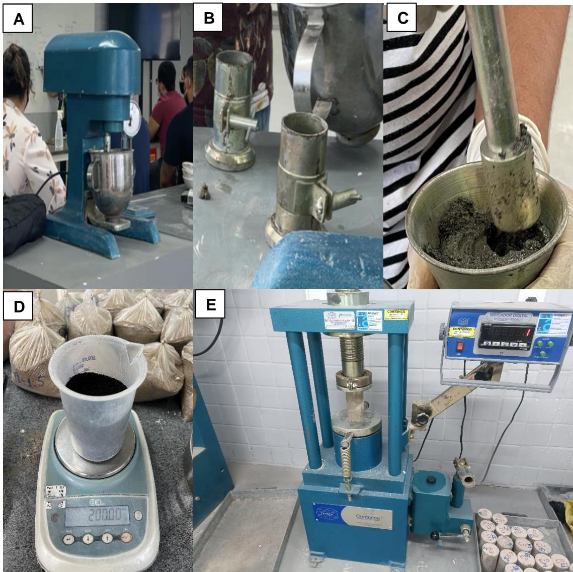
Figura 19 - Equipamentos utilizados para confecção da argamassa para os ensaios: (A) Misturador mecânico de argamassa, (B) Molde cilíndrico, (C) Balança, (D) Soquete, (E) Prensa para os ensaios de compressão
