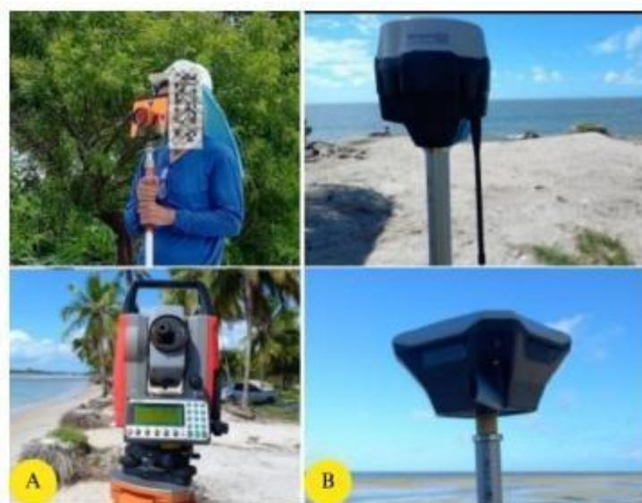
Após a realização do levantamento topográfico, os dados obtidos em campo — incluindo latitude, longitude e altitude — foram organizados em formato tabular e transferidos para o computador. Em seguida, foram processados em um software acadêmico gratuito de modelagem e desenho. A geração dos desenhos topográficos e o cálculo dos volumes foram
